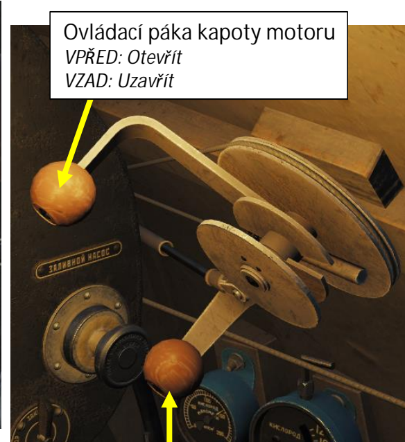
Ovládací páka chladiče motorového oleje VPŘED: Otevřít VZAD: Uzavřít
