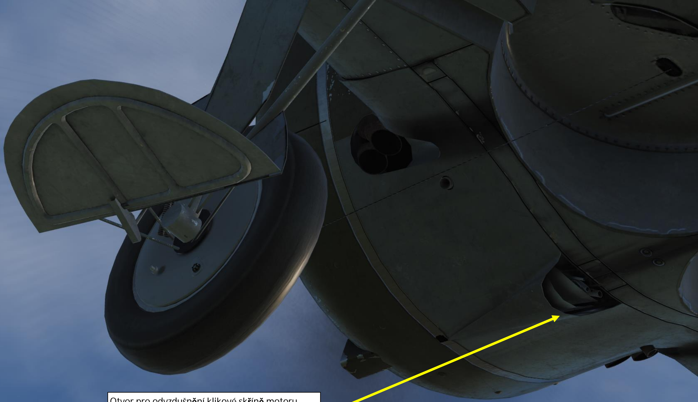
Otvor pro odvzdušnění klikové skříně motoru Součást vzduchového systému klikové skříně motoru, který vychází z odlučovače vzduchu od oleje. Po manévrech s vysokým G může z tohoto otvoru vytékat značné množství oleje.
